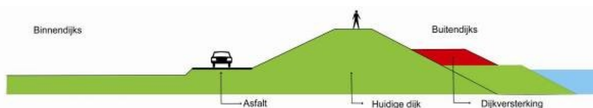
Figuur 3.4: Aanbrengen buitenberm (nieuw) (macrostabiliteit buitenwaarts)
