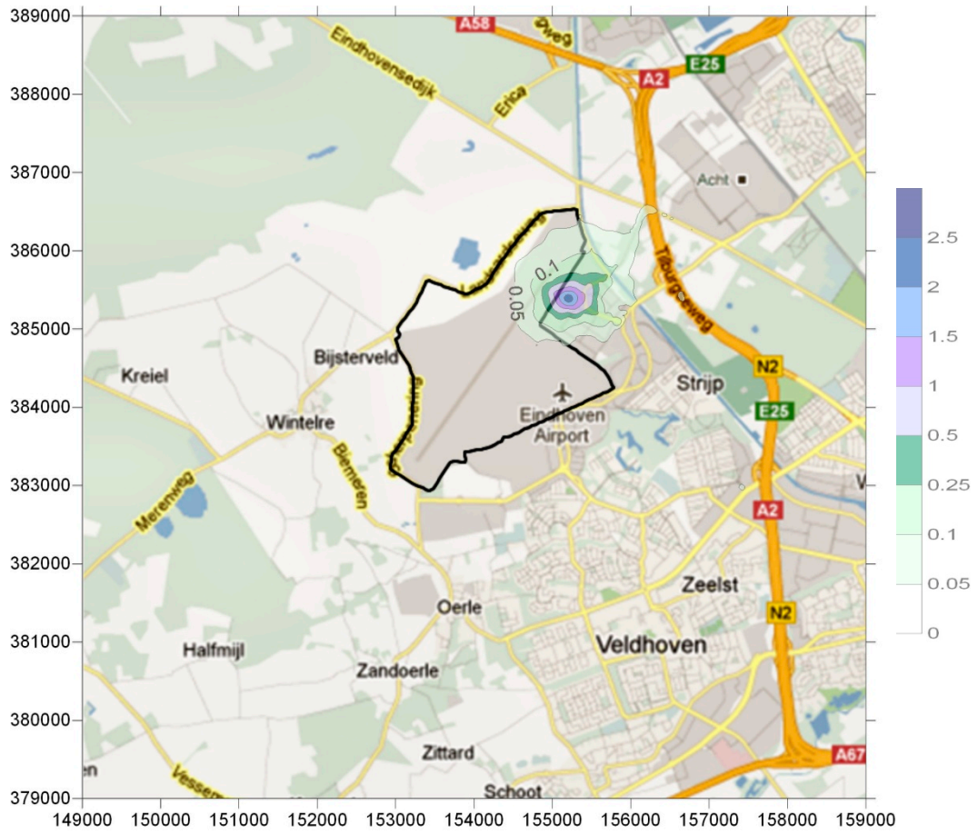
Figuur 18 Effect van scenario D ten opzichte van scenario A op de jaargemiddelde concentratie PM10 in 2014 (in µg/m3). De grens van de militaire basis is met een zwarte lijn aangegeven
