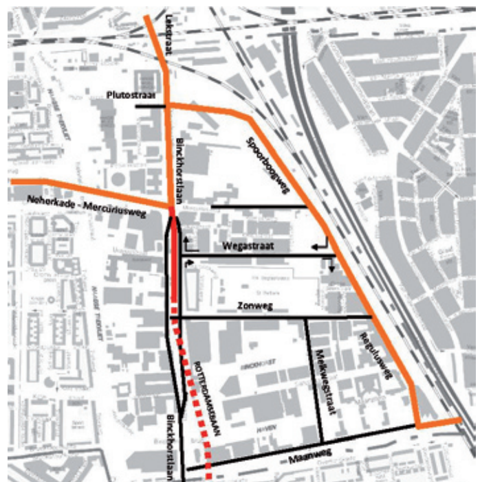
figuur 3.8 Schets dubbele 'T-aansluiting' en aansluiting Verlengde Regulusweg via de nieuwe Spoorboomweg op de Binckhorstlaan
