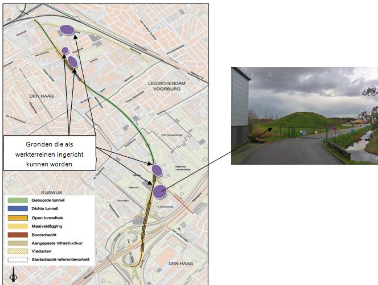
figuur 15.4 Locaties werkterreinen Rotterdamsebaan
