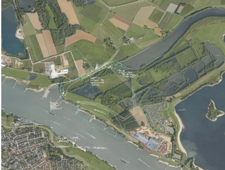
Figuur 4-10: Schetsontwerp kleine haven met oevergeul Oude Waal.
