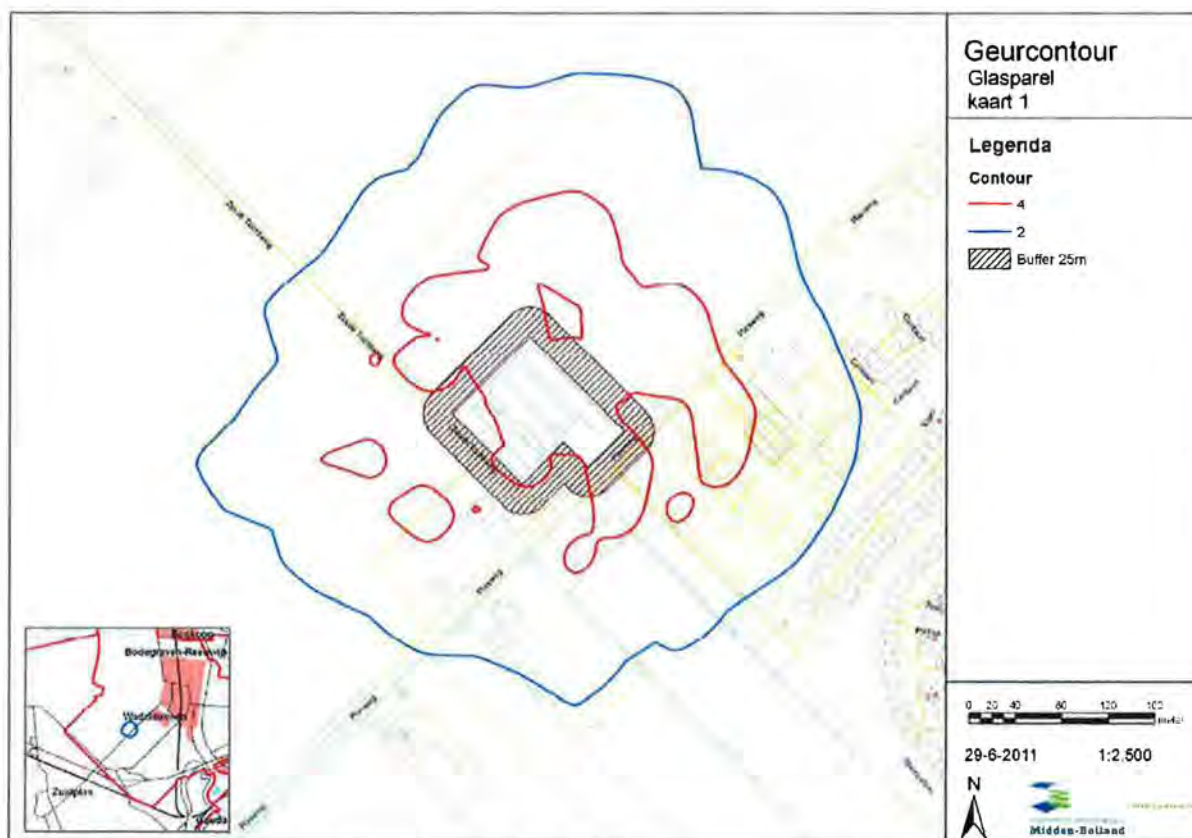
Figuur 6: Berekende geurcontouren en afstanden rondom het bouwblok van de pluimveehouderij Plasweg 37a.
