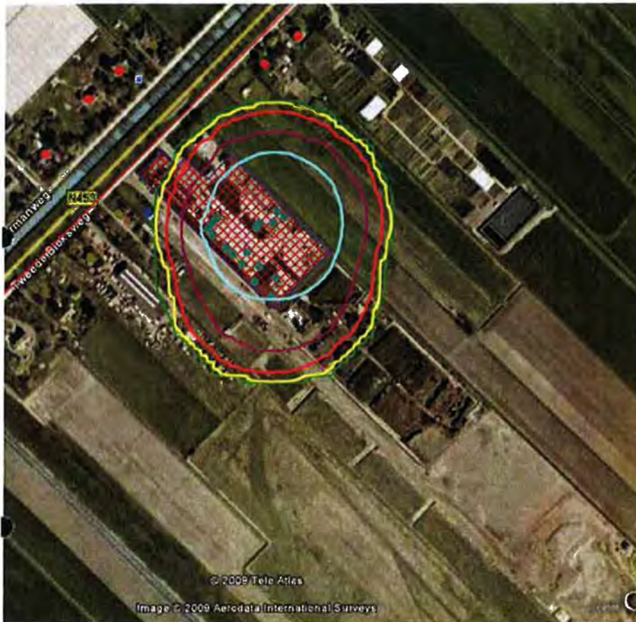
Figuur 9: PR contouren Vis Waddinxveen B.V
