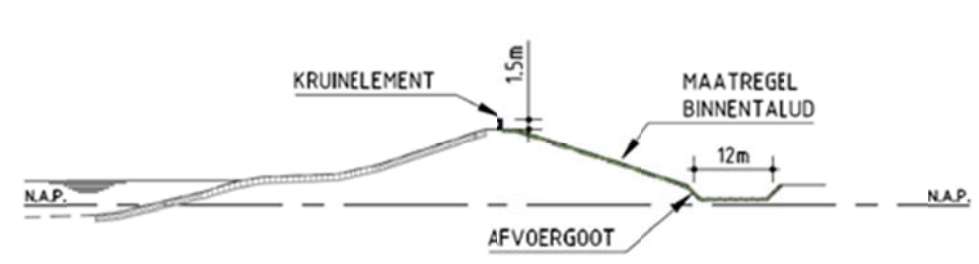
Afbeelding 6: Oplossingsrichting: consolideren landwaarts (Hondsbossche Zeewering)
