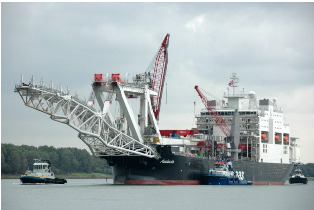
Afbeelding 5: Voorbeeld van een pijpenlegger
