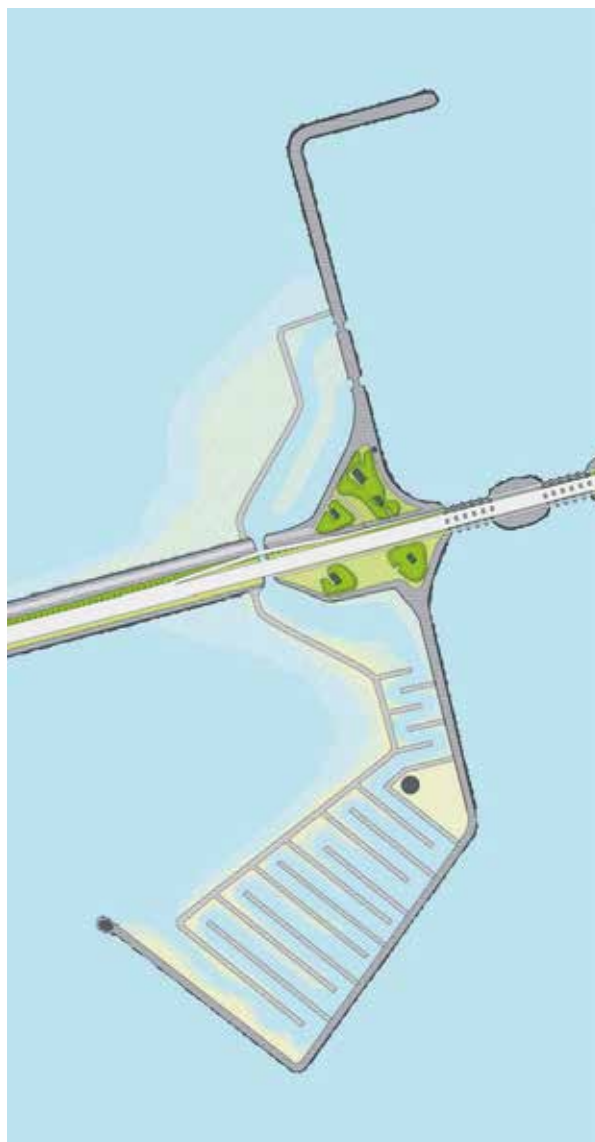
Model vismigratierivier vormgegeven als technisch bouwwerk met dammen en minder ruimte beslag in de Waddenzee
