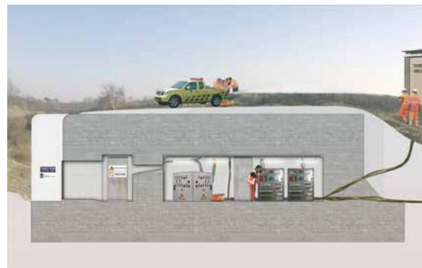
Kazemat als technische ruimte
