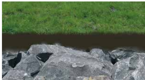
Stortsteen afgedekt met grond en gras
