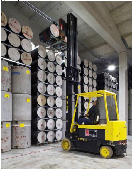
Figuur 3 Stapeling van vaten met laag- en middelradioactief afval in het LOG
