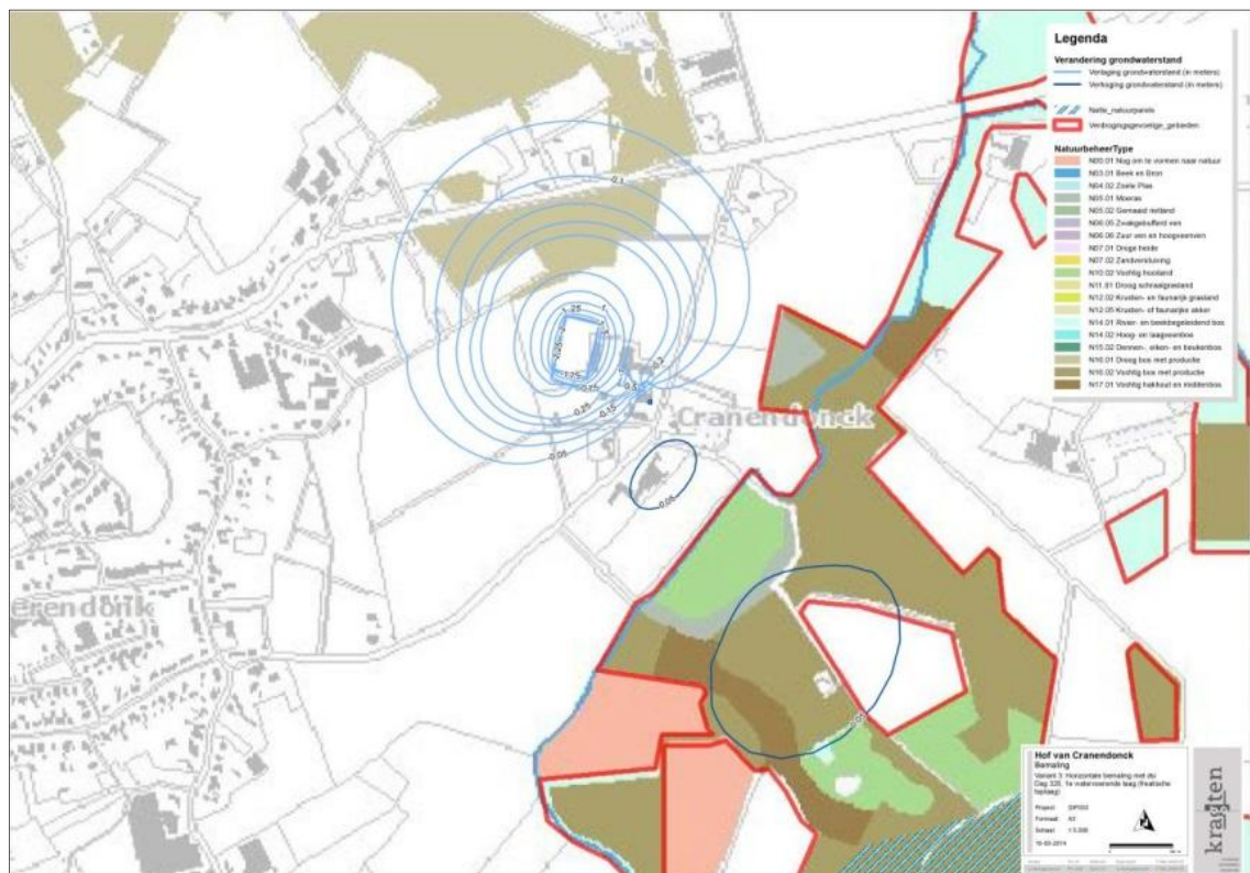
Afbeelding 69: Grondwaterstandsverandering na 320 dagen bemaling bouwput
