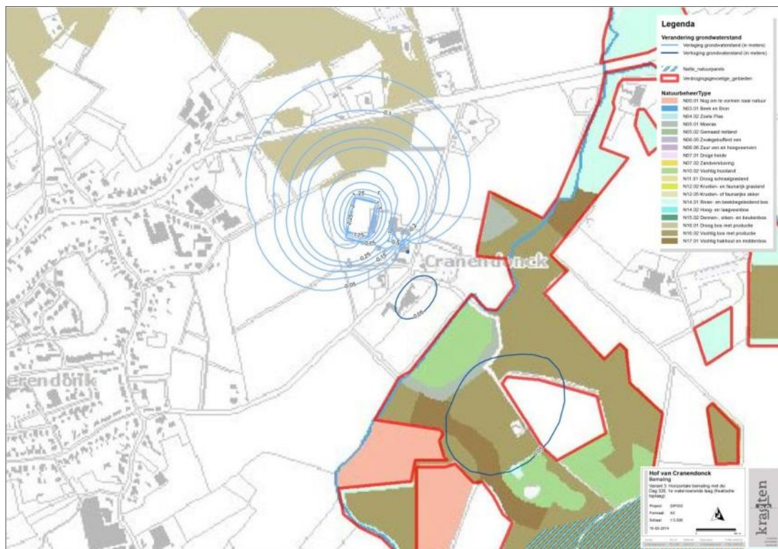
Afbeelding 50: Invloedsgebied grondwaterstandsverandering na 320 dagen bemaling (lichtblauwe lijnen: grondwaterstanddaling; donkerblauwe lijnen: grondwaterstandstijging; rood omlijnd: grondwaterafhankelijke EHS). Bron contouren: Inpijn Blokpoel Ingenieursbureau, 2014.
