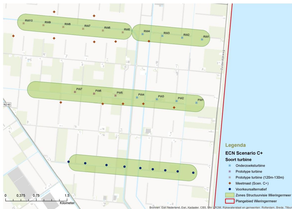
Figuur 14.1 Scenario C+ van ECN (twee noordelijke lijnen) en de turbines van Windpark Wagendorp en het verlengde daarvan
