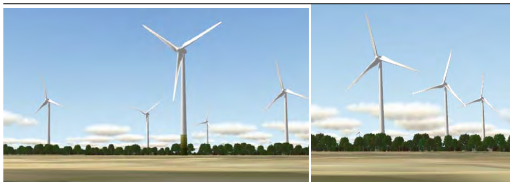
Figuur 5.7 Grid versus lijnopstelling (bron afbeelding: ROM 3D)
