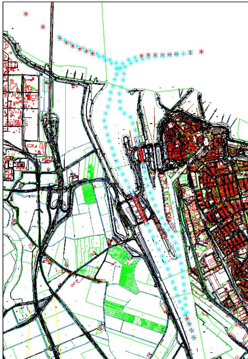
Figuur 5.6 Overzicht gemodelleerde route zeevaart (huidige situatie 2012), de blauw sterren geven aan waar het manoeuvreren voor scheepsgrootteklasse 5 t/m 8 is gemodelleerd
