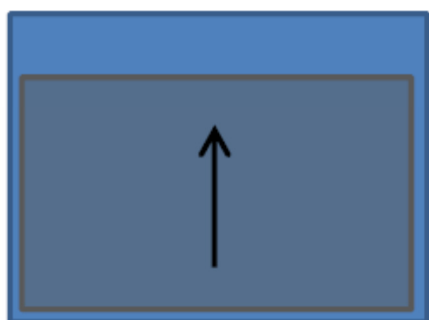
Klep van onder (functioneert als overlaat indien deels gesloten, eerst verdronken overlaat, later volkomen overlaat)
