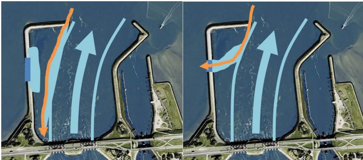
Figuur 6-4. De ingang van de VMR die links is groter met een beperkte pluim langs de oever. Hierdoor kunnen eventuele grotere vissen die langs de spuipluim zich oriënteren, maar op de grens van de spuipluim zwemmen de ingang van de VMR missen. Rechts een situatie waar de pluim van de VMR, gecreëerd door een nauwere ingang, reikt tot de spuipluim waardoor vissen die langs de spuipluim zwemmen de pluim van de VMR kunnen oppikken.
