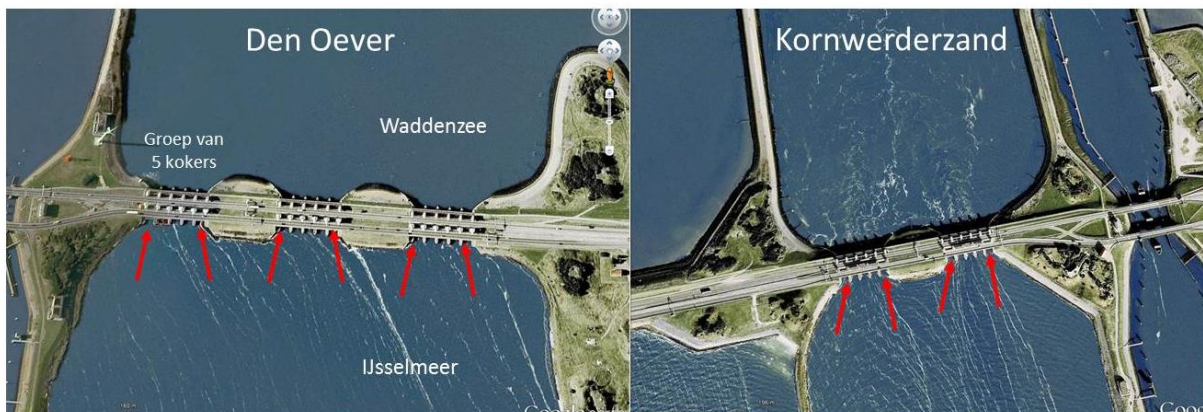
Figuur 2-2. Kaartjes met de spuicomplexen bij Den Oever en Kornwerderzand. Den Oever heeft drie groepen van vijf spuikokers en Kornwerderzand heeft twee groepen van vijf spuikokers. Bij de buitenste schuiven van elke groep van spuikokers (rode pijlen) kan aangepast spuibehaar worden toegepast (paragraaf 2.1.2), waarbij de schuiven op een kier worden gezet. Een kier wordt gecreëerd doordat de schuiven maar gedeeltelijke worden opengezet en er een kleine ruimte ontstaat tussen de onderkant van de schuif en de bodem (zie Figuur 2-5).
