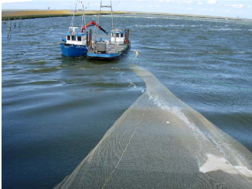
afbeelding 2.2. Net van het grote vangtuig en het bunkerschip bij aanvang van een spuiperiode
