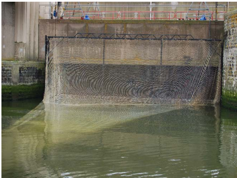
afbeelding 2.3. Het grote vangtuig aan de Waddenzeezijde voor aanvang van een spuiperiode
