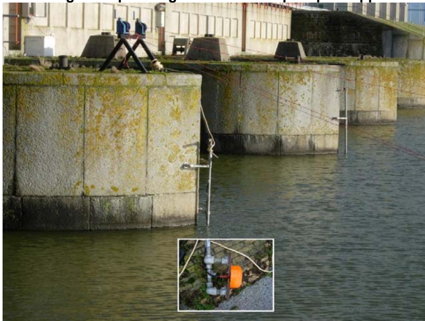
afbeelding 2.1. Opstelling van de sonar op de pierkoppen
