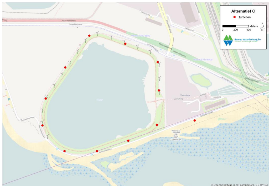
Figuur 2.3 Locaties van geplande turbines van Windpark Slufter volgens variant C (rode stippen). De huidige windturbines die bij de opschaling van Windpark Slufter zullen verdwijnen zijn afgebeeld met een windturbine symbol.
