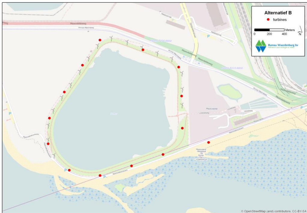
Figuur 2.2 Locaties van geplande turbines van Windpark Slufter volgens variant B (rode stippen). De huidige windturbines die bij de opschaling van windpark Slufter zullen verdwijnen zijn afgebeeld met een windturbine symbol.
