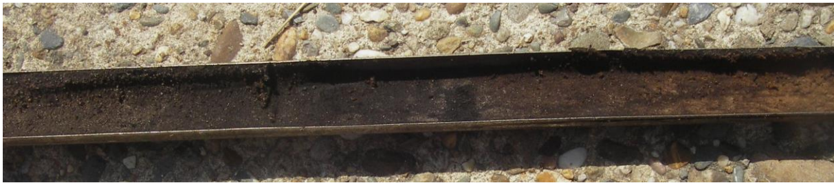
Figuur 18: Foto van boring 18 met in het midden het moerige zand en rechts de laag doorworteld, zwak venig zand.
