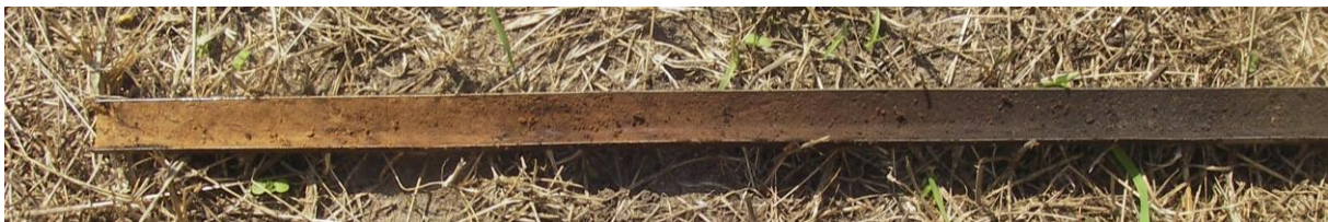
Figuur 17: Foto van boring 17 met het akkerdek (rechts), de B-horizont (midden rechts), de BC-horizont (midden links en de C-horizont (links), zoals ook in de boringen 16 en 17 zijn aangetroffen.
