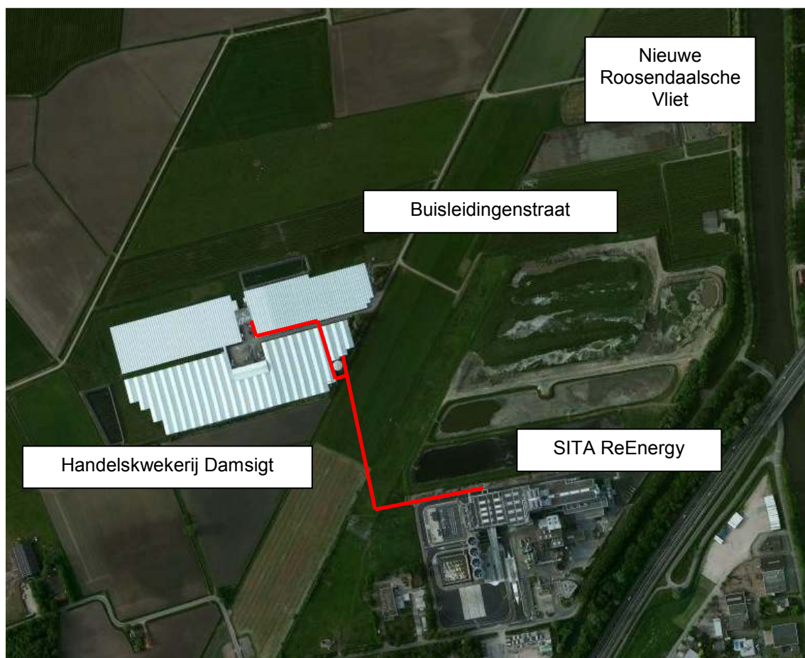
Afbeelding 1: Luchtfoto van huidige kwekerij te Roosendaal met restwarmteleiding
