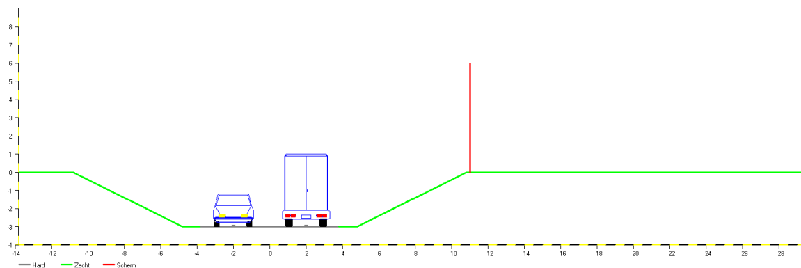
Figuur 2.17 Halverdieupte ligging met een geluidsscherm van 6 meter hoog
