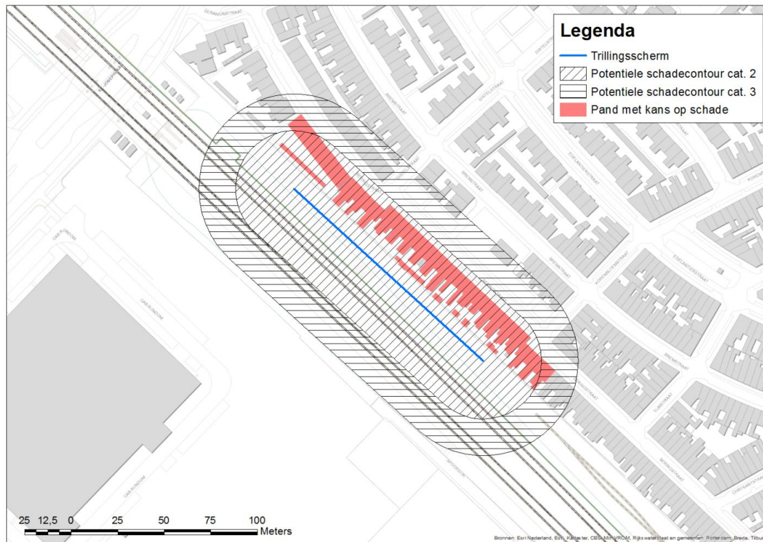
Figuur 37: Schadecontouren bij OTC Seringstraat (intrillen damwanden)
