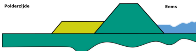
Figuur 6.2 Alternatief: Binnendijkse bermaanleg
