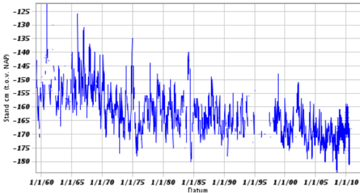
Figuur 37 Fluctuatie van de stijghoogte bij peilbuis B25H0099, buis 1 (filter op NAP -11 m). (Dinoloket, 2015).
