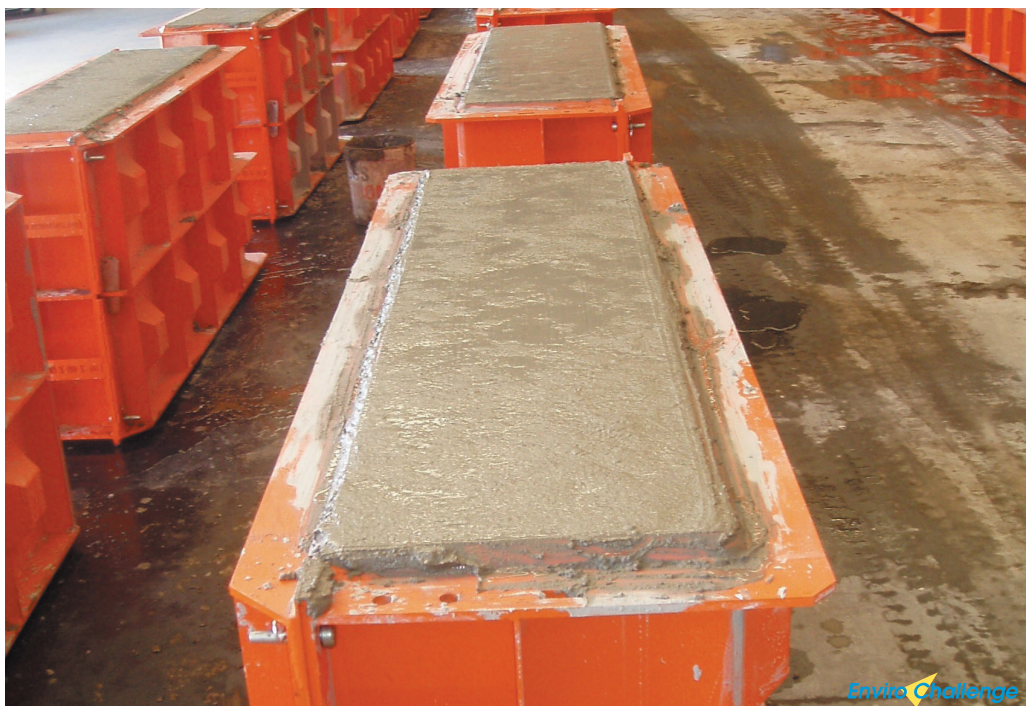
Illustratie 8 : Uitharden van betonproducten in mallen (samenstellingslijn)
