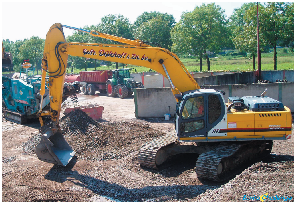
Illustratie 4 : Granuleren van puin (BSA-lijn)
