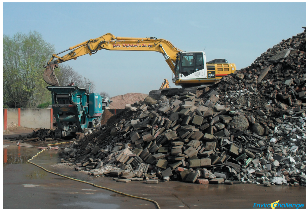
Illustratie 1 : Granuleren van puin
