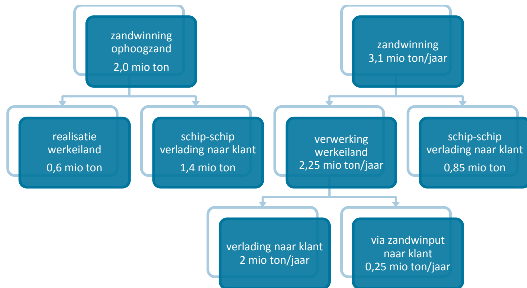
Figuur 3.3: Overzicht grondstromen (links is opstartfase en rechts is werkfase)
