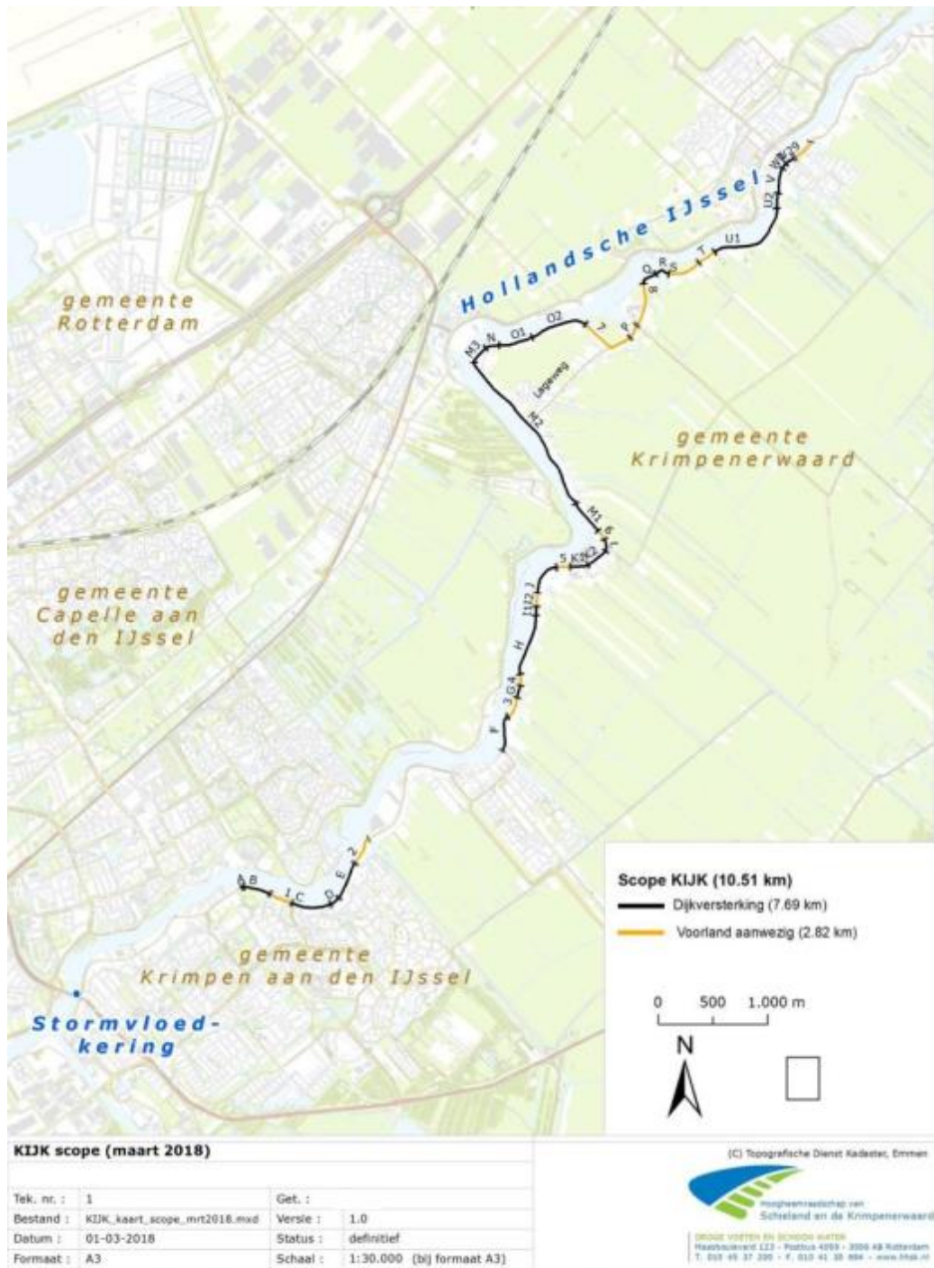
Figuur 2: Projectscope KIJK (30 dijkvakken aangeduid met letters A t/m W en 9 stukken voorlanden aangeduid met cijfers 1 t/m 9) (Bron: NRD)
