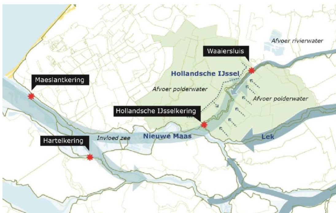
Figuur 1: Weergave systeemwerking Hollandsche IJssel (bron: NRD)
