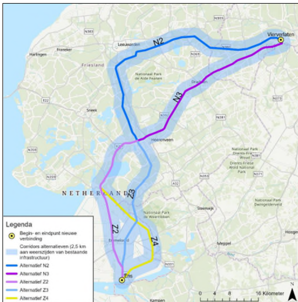
Figuur 1: De te onderzoeken tracéalternatieven voor de nieuwe 380 kV-hoogspanningsverbinding tussen Vierverlaten en Ens voor het planMER (bron: NRD).
