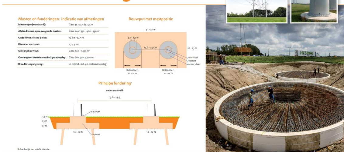
Figuur 2.8 Ruimtebeslag fundering masten
