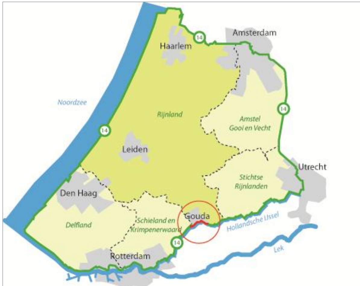
Figuur 1.1: Hollandse IJsseldijk als onderdeel van Dijkkring 14
