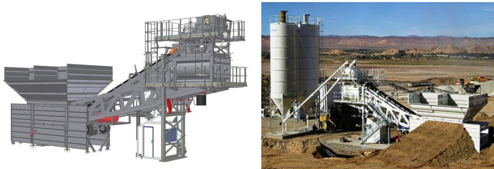
Figuur 2.16 Voorbeeld mobiele betoncentrale (Frumecar 2000)
