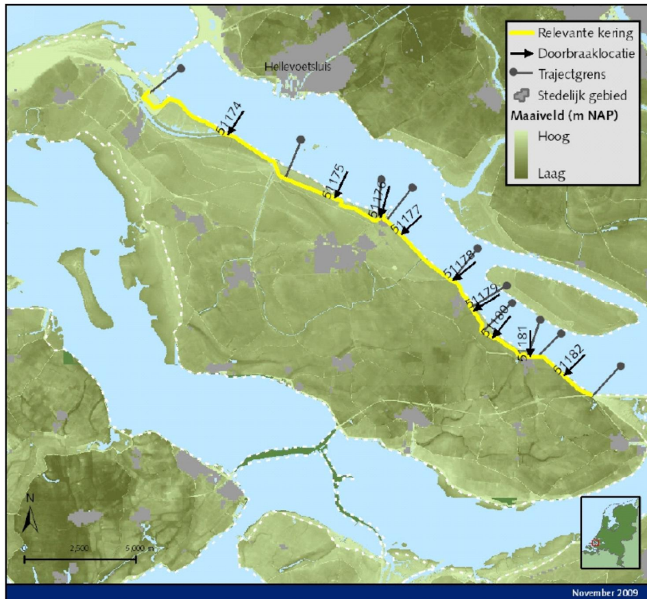
Figuur 4.2 Dijkringdelen en doorbraaklocaties dijkkring 25_2 Goeree-Overflakkee
