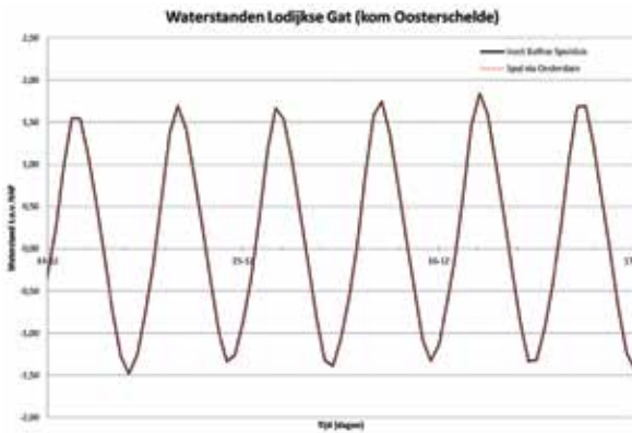
Figuur 45. Waterstandverschillen in millimeters op Oosterschelde (Lodewijkse Gat) bij vergelijking van spuien via Bathse spuisluis of via Oosterdam. Bron: Zuidwestelijk Deltamodel voor Stofstroomanalyses, Deltares 2014.
