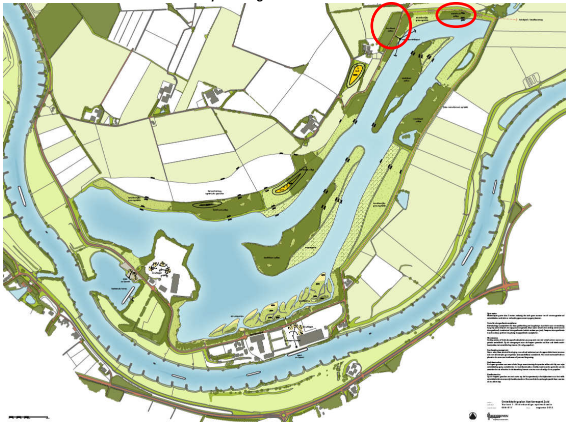
Figuur 6.6 Variant 1. Rode cirkel toon locatie van aanbevolen te verwijderen boscomplexen ten behoeve van reductie opstuwing
