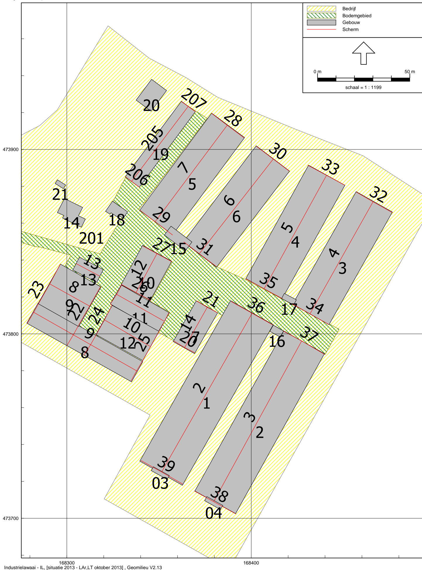
figuur 5: Overzicht rekenmodel met positie bodemvlakken, schermen, objecten
