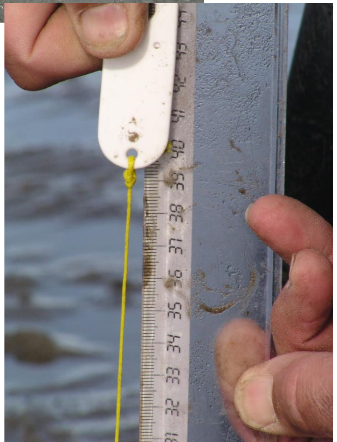
Figuur 5. Meet liniaal met meetvoet. Deze wordt steeds op dezelfde wijze op de bodem gezet waarna de lengte van het meettouw langs de schaal wordt afgelezen.
