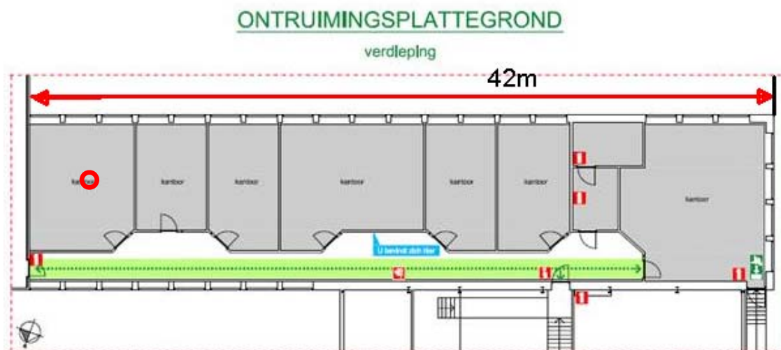
Figuur 4.2: brugkantoor EQIN met trillingmeetpunt vloer (rood)
