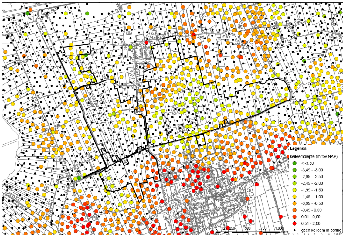
Figuur 2.6 Diepte bovenkant keileem (m tov NAP) in Stiboka en DINO-borings
