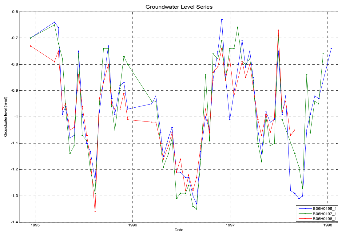
Figuur B1.7 Peilbuizen B06H0195, B06H0198 en B06H0198 (Polder Bombay, filterdieptes op 1,5 tot 2 m - mv). Maaiveldhoogte respectievelijk: NAP -0,57; -0,62 en -0,66 m.
