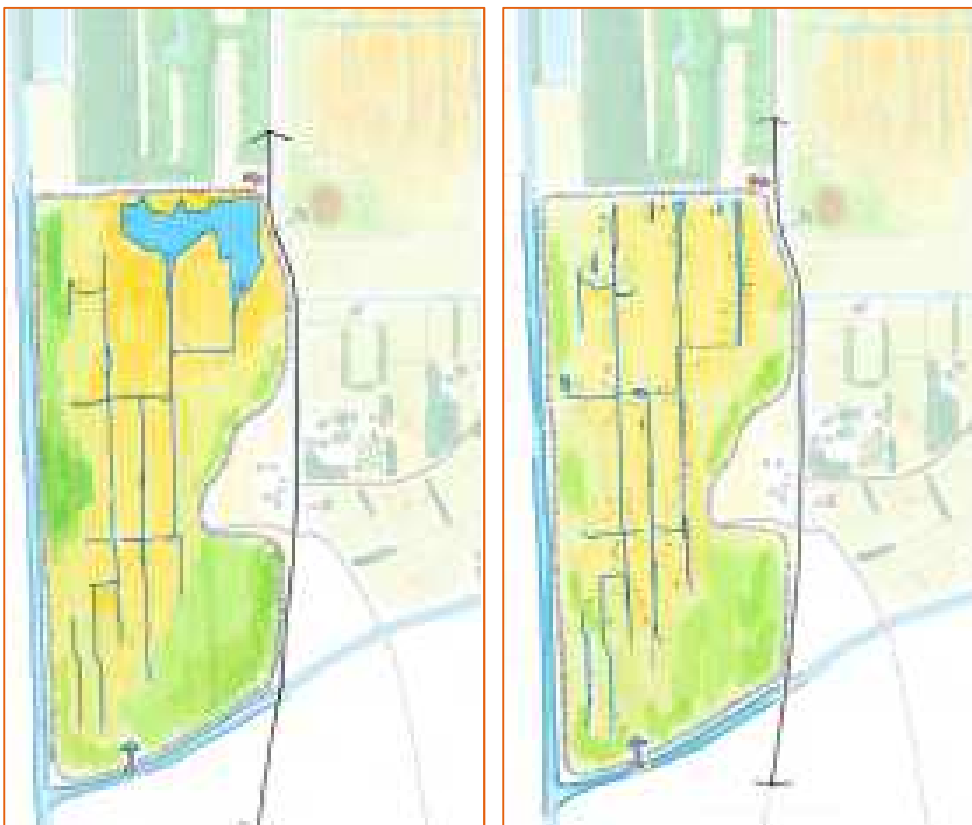
Figuur 5-7 Mogelijke uitwerkingen plas Bakkerom-zuid: links met kleinere en ondiepere plas, rechts met geheel gedempte plas
