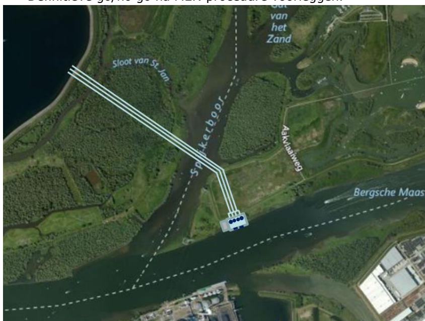
Schets geadviseerde voorkeursalternatief "Bergsche Maas", met 3 x DN2000 persleiding.
