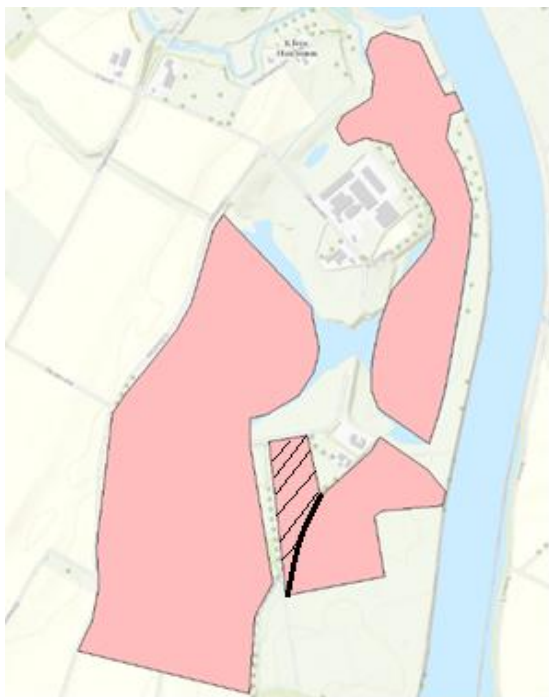
Figuur 5.3. Ligging van de plassen in de eindsituatie. Het verschil met figuur 5.2 is nu dat een gronddam met overlaat is aangebracht op de grens van de nevengeul en de afrondingsvergunning. Hiermee wordt het peil in het gebied van de afrondingsvergunning verhoogd.
