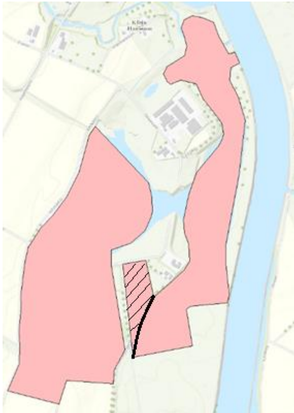
Figuur 5.2. Ligging van de plassen in de realisatiefase van de zandwinning. Aan de zuidgrens van de uitbreiding is de plas nog niet in oostelijke richting voltooid. Dat houdt in dat in dit plasdeel de taluds en bodem nog niet zijn afgedekt met slecht doorlatend materiaal. Het gearceerde deel van de afrondingsvergunning is geheel opgevuld met grond met een lage doorlatendheid.
