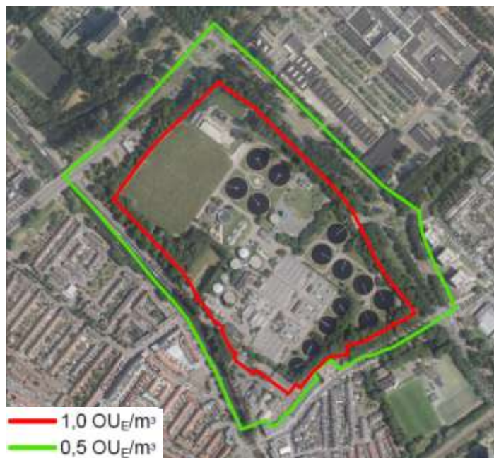
Figuur 9.22: Gewenste ligging geurcontouren rondom nieuwe installatie (bestuurlijk uitgangspunt)
