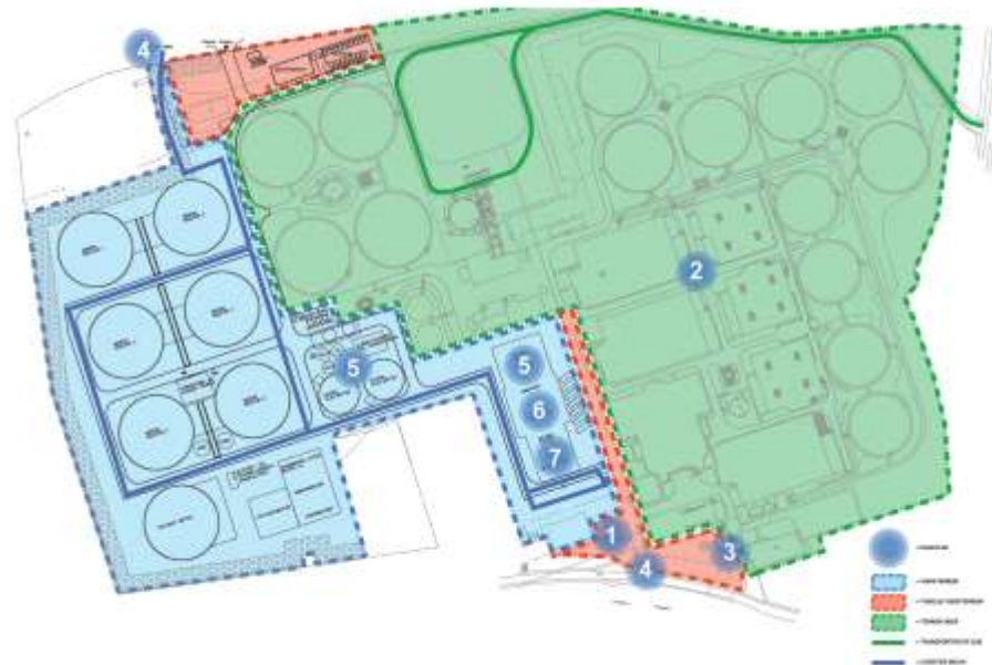
Figuur 9.7: Globaal overzicht raakvlakken en risicovolle activiteiten tussen bestaande en nieuwe installatie (aanbiedingsontwerp) [61]
