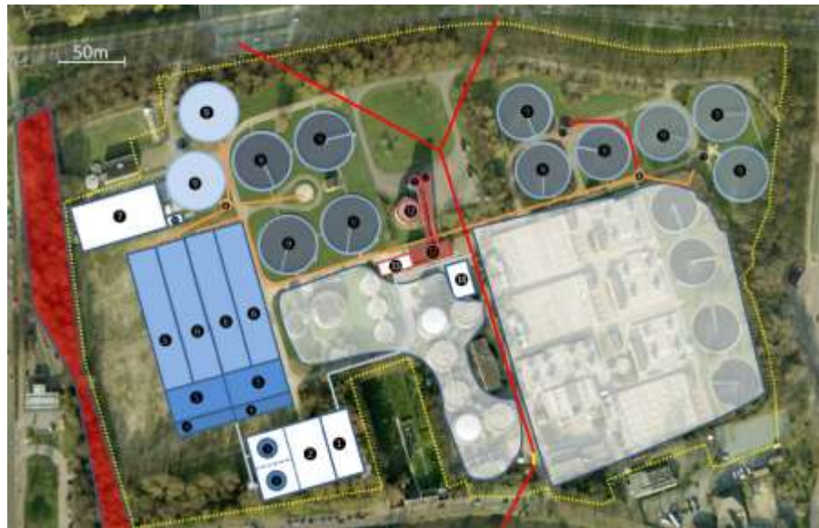
Figuur 8.4: Mogelijke lay-out nieuwe mUCT installatie
