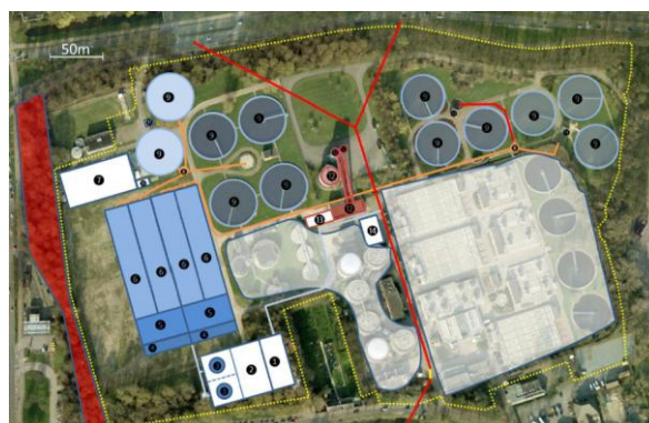
Figuur S.9: Mogelijke lay-out nieuwe Nereda ® -installatie
