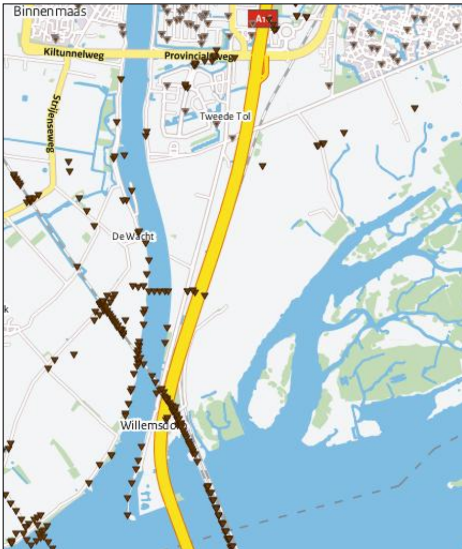
Figuur 36: De in het onderzoek gehanteerde geotechnische sondeonderzoeken die beschikbaar zijn bij het DINOloket. De locaties van de sondeonderzoeken zijn aangegeven met een driehoek.
