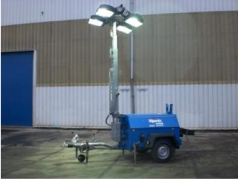
Figuur 3 Voorbeeld van bouwverlichting met richtbare lampen
