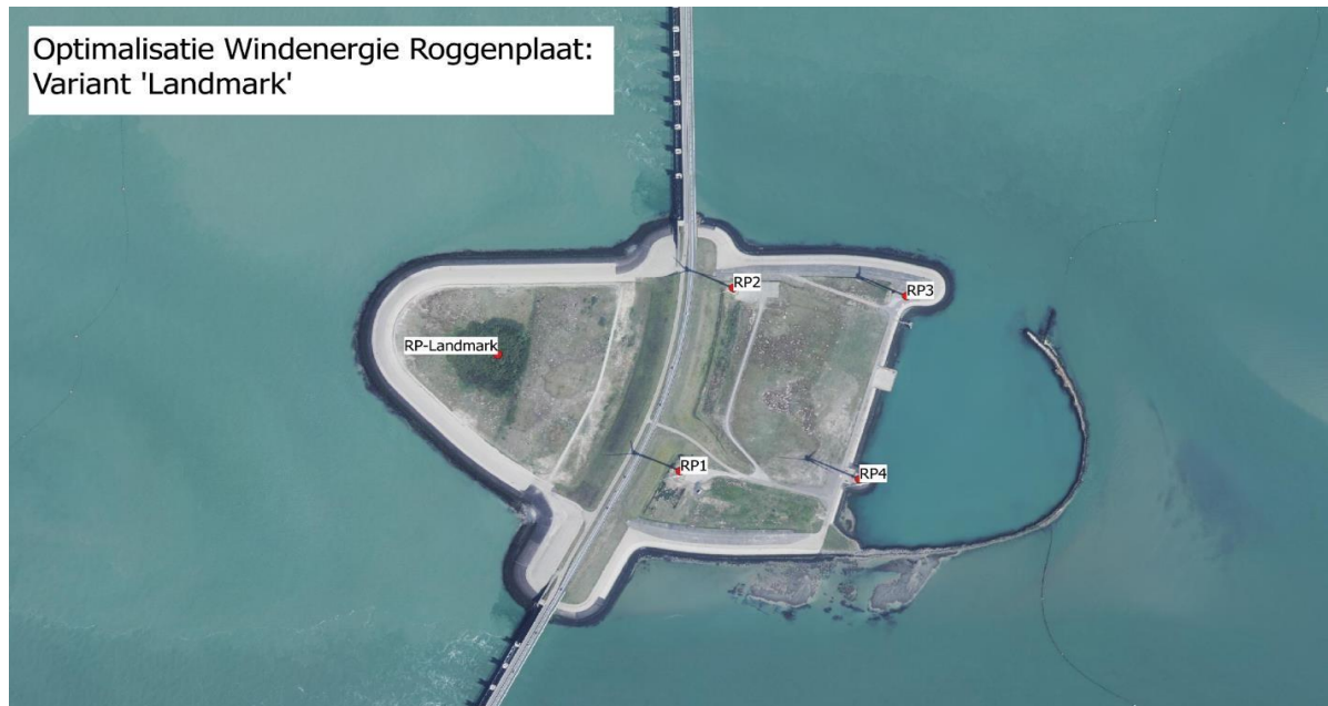
Figuur 2. Variant 'Landmark': 1 turbine 120-140 m 1 diameter op 100-140 m 1 ashoogte (minimale tiplaatte 40 m 1 ), bijv. Enercon EP4.
