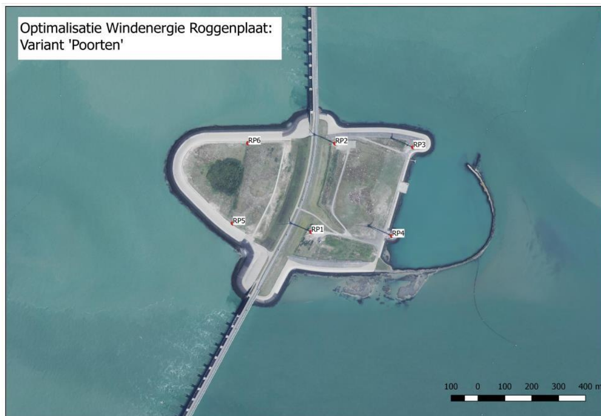
Figuur 1. Variant 'Poorten': 2x vergelijkbare turbines als bestaande windpark op RP-Oost (Enercon E82 op 78m 1 ashoogte).
