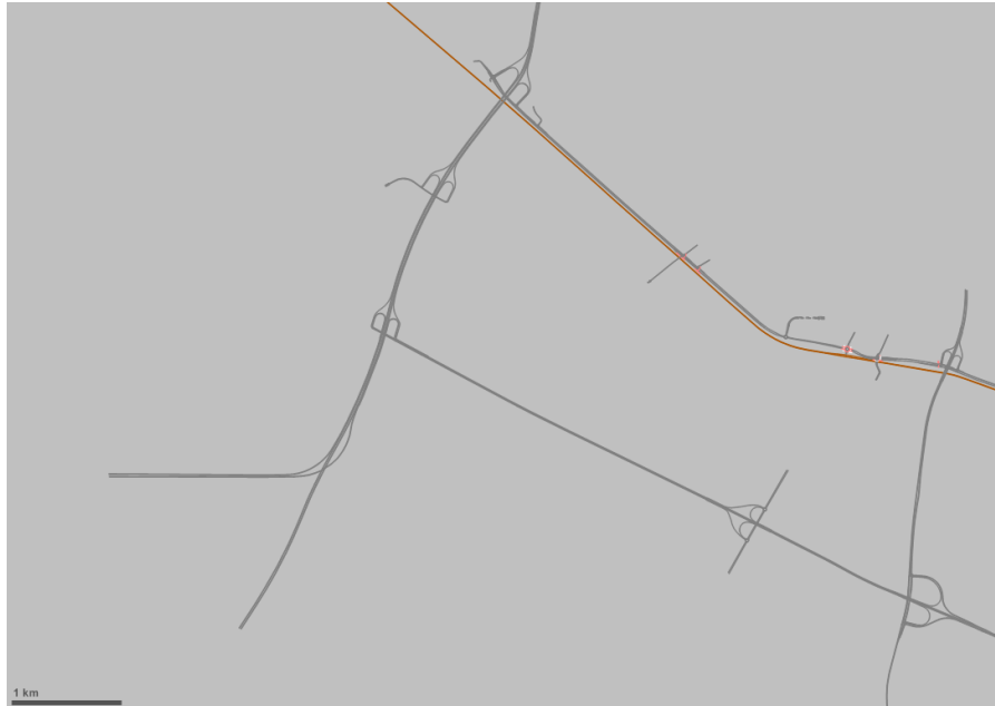
Figuur 3.1: Het netwerk zoals opgenomen in de Vissim simulatie, bijgaand voorbeeld laat zien: alternatief golfbaan met variant aansluiting.
