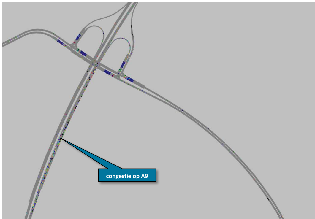
Figuur 6.4: knelpunt in de Heemskerk variant in de avondspits: de uitvoeger heeft te weinig capaciteit (in de ochtendspits is het probleem vergelijkbaar vanuit de A9 vanuit noord) (screenshot uit dynamische simulatie, gekleurde stipjes representeren voertuigen).
