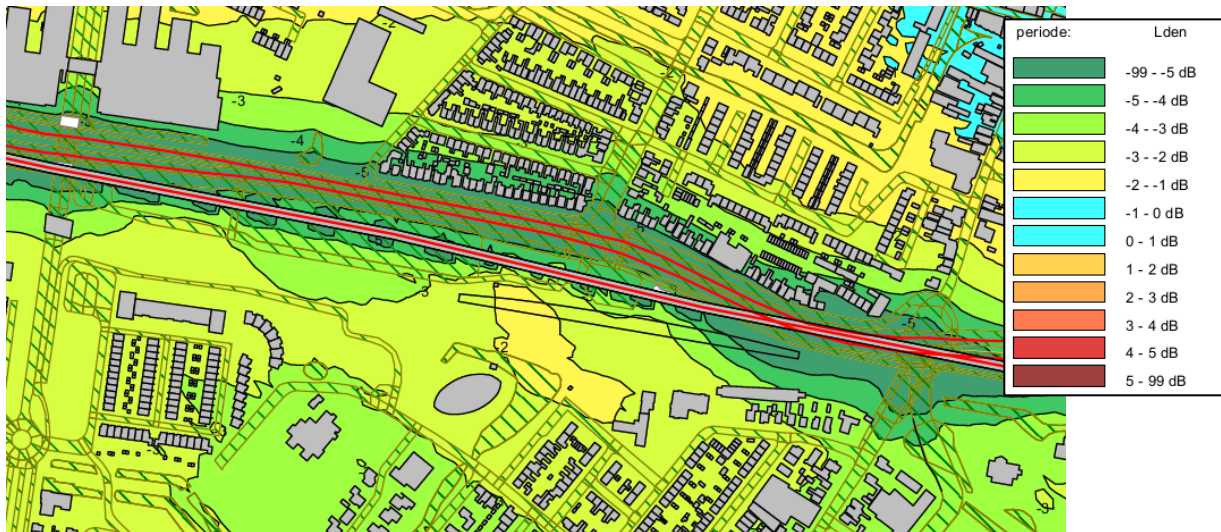
Figuur 4.14: Verschilplot geluidcontouren verhoogde ligging (schermen 2 m), verschil met referentie
