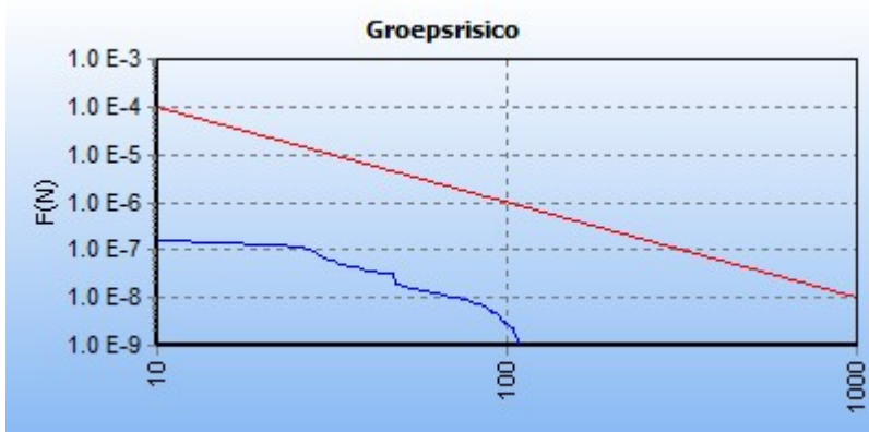
Figuur 4.3 FN curve voor 2710_leiding-A-585-deel-Noord van N.V. Nederlandse Gasunie voor de kilometer tussen stationing 4170.00 en stationing 5170.00
