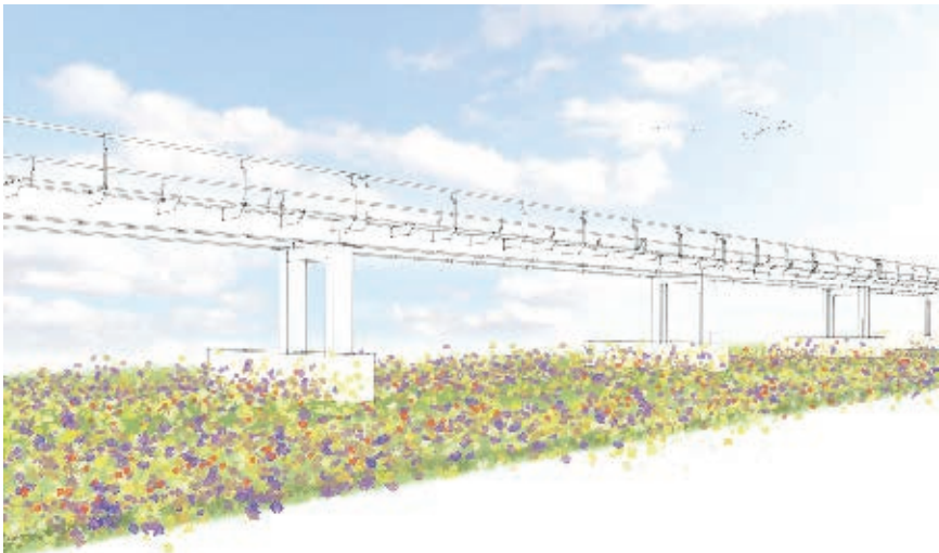
3D weergave van een mogelijke uitwerking van fietsbrug: brugpijlers op basis van het historische ritme (staan op bestaande in situ bewaarde brugpijlers), horizontale liggers met dimensies van oorspronkelijke brug (bron IPV Delft)
